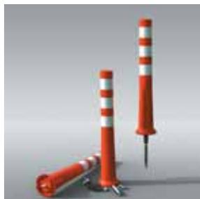
視線誘導標をねじ込むだけで簡単に設置及び交換メンテナンスを可能にしました。ハイブリッドアンカーは施工と同時に十分な付着強度を発揮しますが、さらに接着剤の硬化後には強力な付着強度が得られます。アスファルト路面加工（切削・オーバーレイ）時にはハイブリッドアンカーの上部（50mm）を取り外して対応できます。
