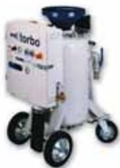
特許メカニズムから発生する高圧サイクロン状態のウォータミストとミスト内に混入された研削材により、高い洗浄能力と飛散養生の軽便化機能を同時に実現。研削材はドライブラストより60%節約、水は高圧洗浄機の1/10、粉じん発生も極力抑えることが可能となっており、対象物に静電気を発生しないことから、可燃性雰囲気にも対応可能。
