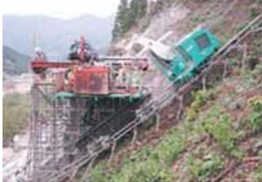
地すべり対策、トンネル深礎、砂防堰堤、山間部の鉄塔や送水管設置、間伐集材搬出など、急傾斜地・不整地の様々な現場において、バックホウやボーリングマシンなどの重機や生コン、土砂、鉄筋などの資機材運搬の安全性と作業効率向上に貢献します。4t積載時でも45度の斜面を分速40mで走行でき、設置に伴う地形改変、伐採が殆ど不要で自然環境に優しい。また、強風など天候の影響を受けにくく、安全で安定した運搬手段です。
