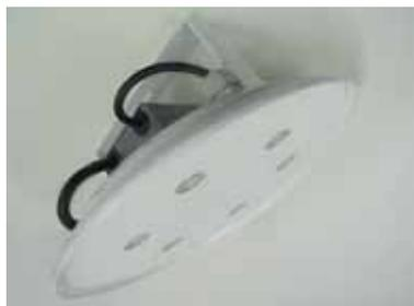
倉庫など、従来水銀灯を使用している環境をLED照明に置き換えることにより、水銀レス、消費電力の低減、長寿命によるランプ交換費の削減、メンテナンス作業の省力化、産業廃棄物の低減など、省エネルギーや環境配慮が図れます。また、LED照明として優れた放熱設計による小型・軽量化（3.5kg）および、高出力LEDにレンズを使用し筐体の薄型を図っております。
