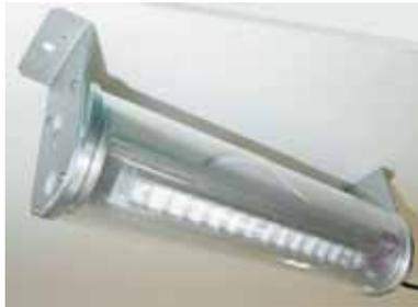
従来の蛍光灯をLED光源にすることで水銀レス、長寿命、消費電力低減を実現、省エネルギーや産業廃棄物低減などの環境対策を図れます。明るさもLEDに角度を付けレンズを併用することで、広範囲で一定の照度を確保しています。器具自体は保護等級IP67の防浸構造の上、重量1.5kgと非常に軽量です。使用電圧は100V/240Vに対応しています。共同溝・とう道、地下トンネル、アンダーパスなど様々な用途でお使いいただけます。
