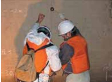
衝撃弾性波法や電磁波レーダ法などの非破壊調査やコアを用いた試験・分析などを組み合わせたコンクリート構造物の調査・診断技術
